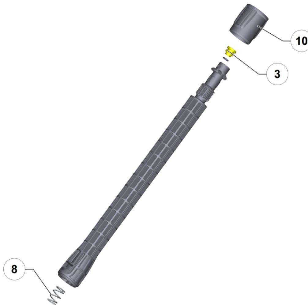
1 1-ступенчатая удлинительная трубка 0,4 м (2.643-240.0)
