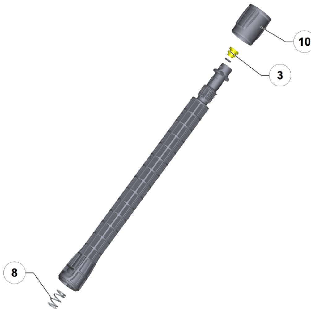
18 1-ступенчатая удлинительная трубка 0,4 м (2.643-240.0)
